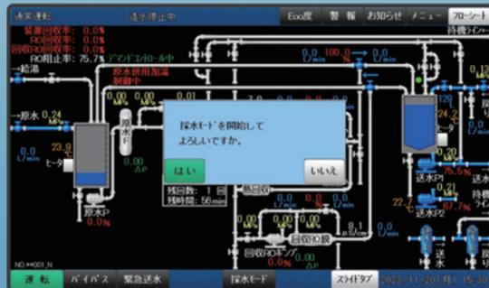
**【特徴】** <採水>モードは、RO原水（前処理水）中の残留総塩素、硬度をチェックする為のサンプル水を採水するモードです。<採水モード>が開始されると、原水ポンプが運転し、自動フラッシングMVが開き、前処理水ラインに原水が通水されます。
